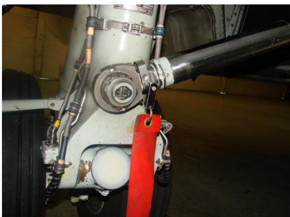
Рис. 13.2. Установка страховочных пинов (штырей), основные стойки шасси.
