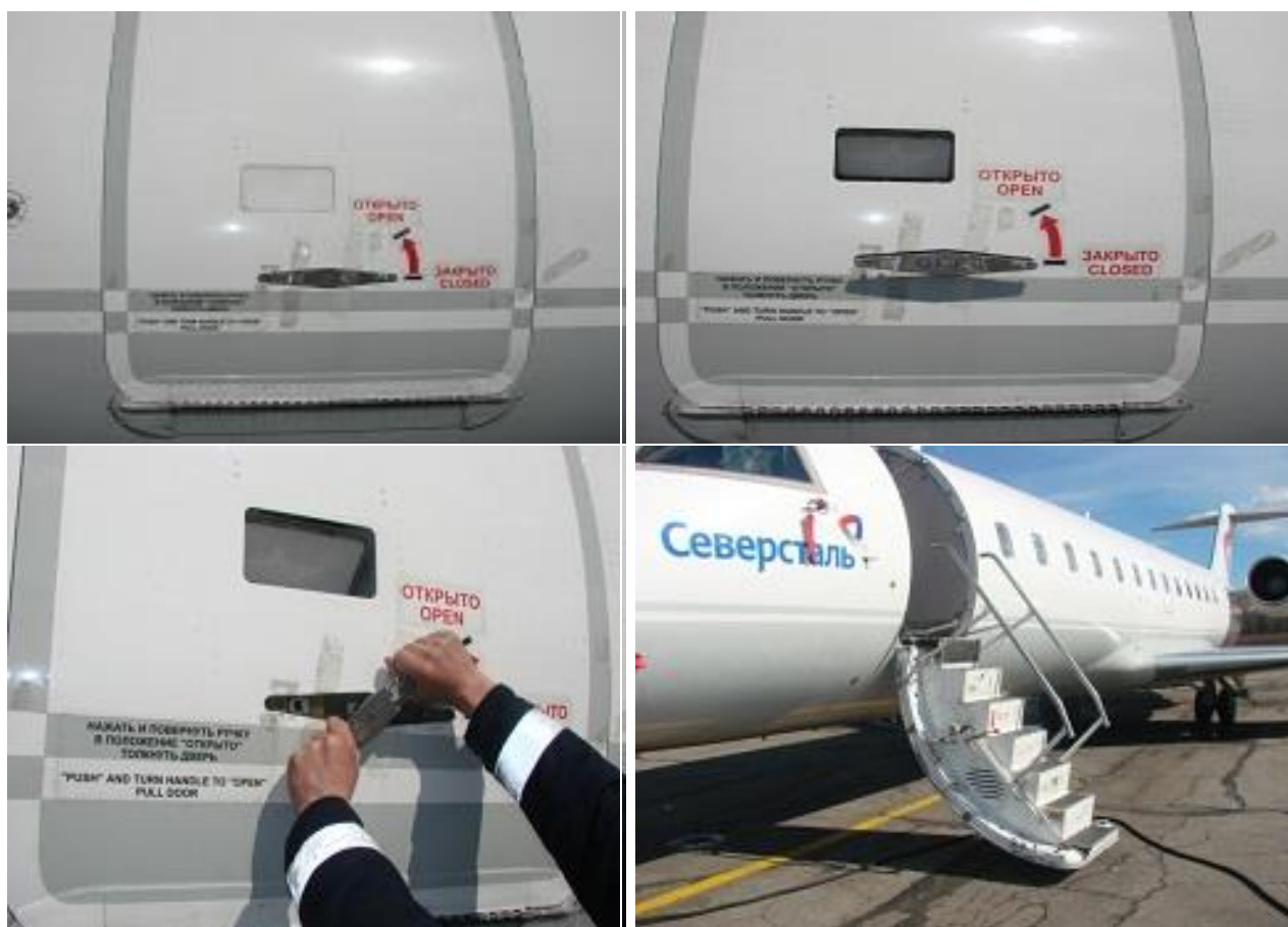
Рис. 3.1. Открытие пассажирской двери с поворотной рукояткой (закрытие – в обратном порядке)
