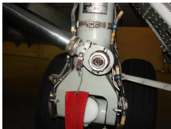
Рис. 13.2. Установка страховочных пинов (штырей), основные стойки шасси.
