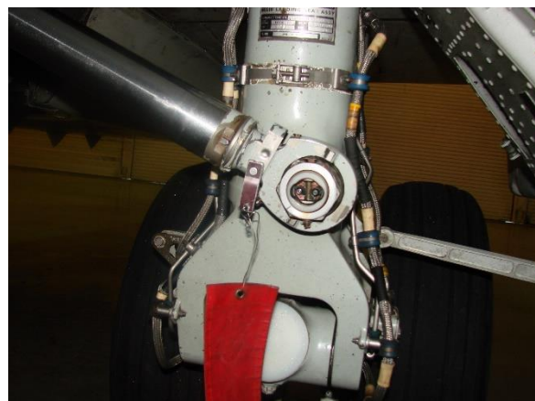
Рис. 12.2. Установка страховочных пинов (штырей), основные стойки шасси.
