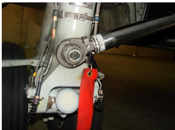
Рис. 12.2. Установка страховочных пинов (штырей), основные стойки шасси.
